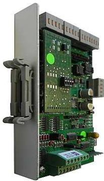
Abbildung: ADP4000 mit Alu-Winkel für die Hutschienenmontage (Standard)
